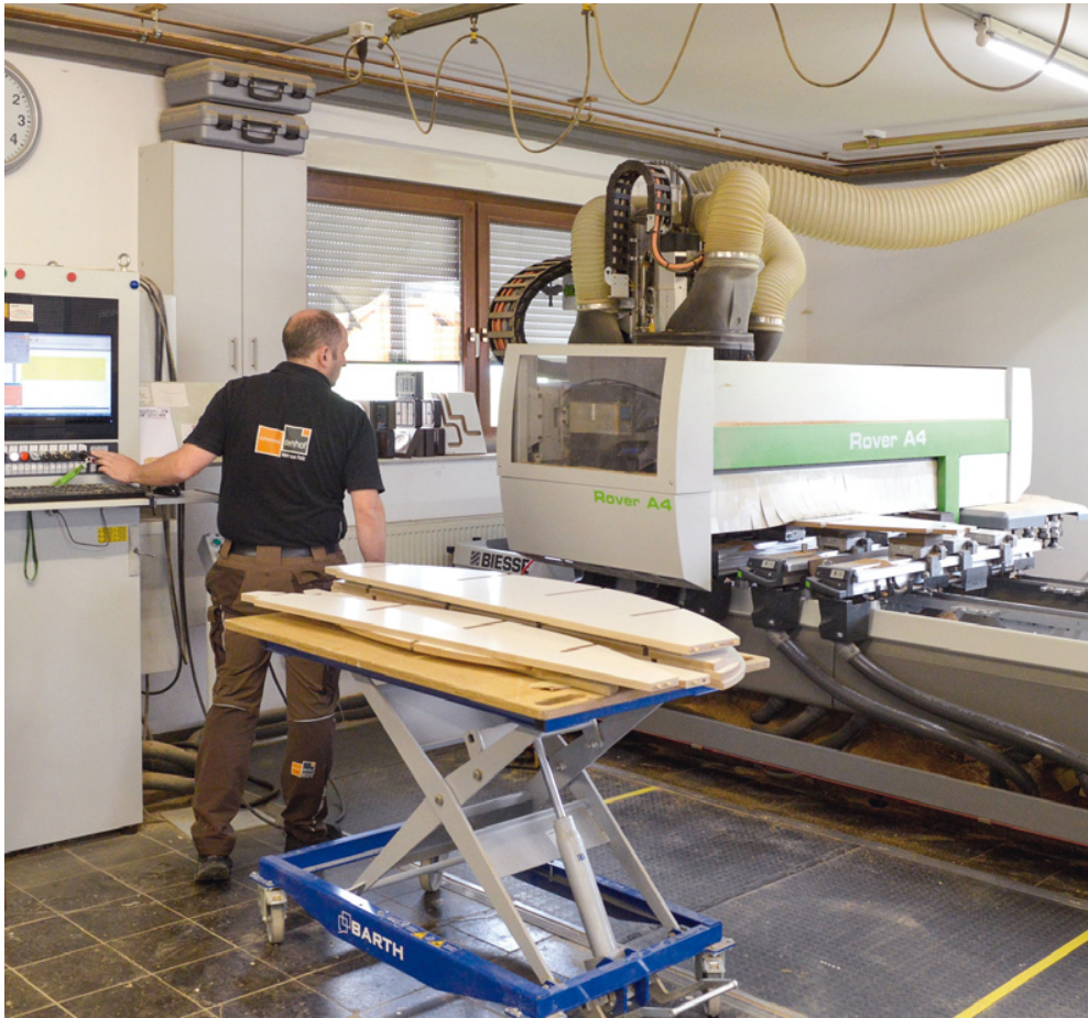
Auf seiner Rover A4 fräst Jens Denhof die Einzelteile des Form.Bar-Regals
